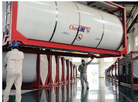
ISOCONTENEDORES (Corrosión Clase 8)
